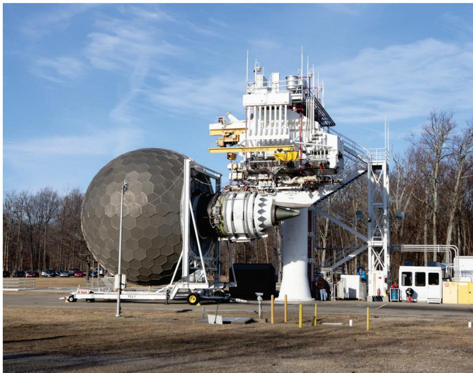
*Banc d'essais de Peeble avec le moteur GENx et ses pièces en CMC
