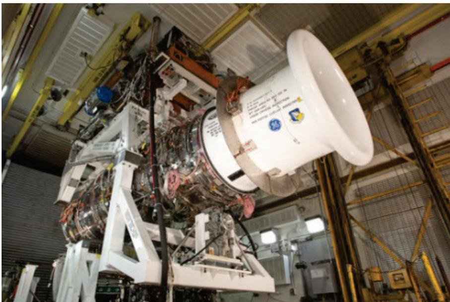
*Banc d'essais du moteur F404 équipé d'aubes de turbines en CMC
